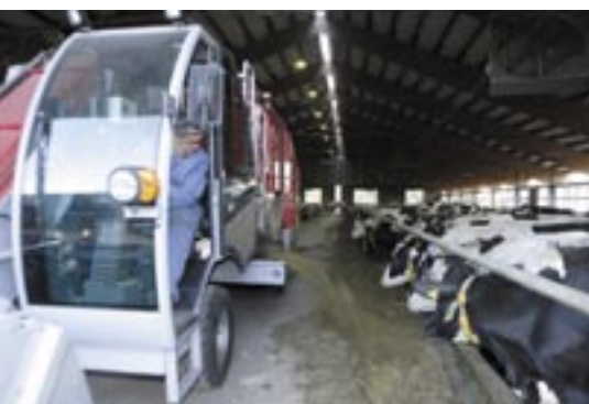
Auf Wunsch gibt es beidseitig Fütterungsluken oder ein um je 30 cm seitenschiebbares Austragband. Ein Band am Heck ist bauartbedingt nicht lieferbar.
