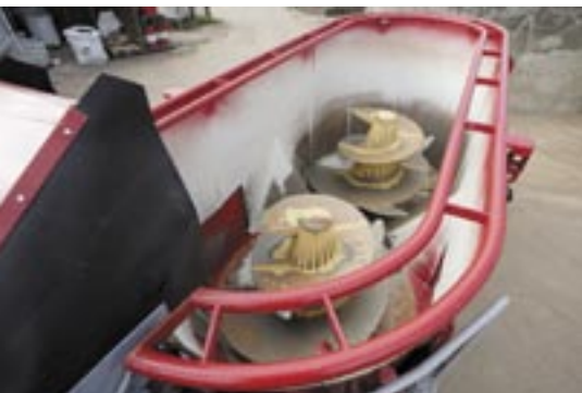
Der Strohring ist serienmäßig eingebaut. Die Schnecken verfügen über zwei Windungen und fünf einstellbare Messer. Links im Bild die Haube, die den Wurfbogen des Futters variabel begrenzt.
