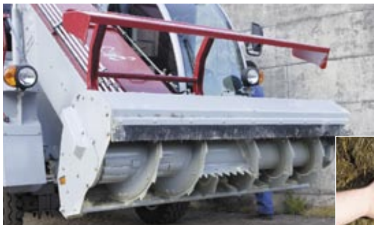
Die patentierte Strukturwalze dreht mit maximal 400 U/min. Auf diese Weise soll das Futter schonend aus dem Stock entnommen werden. Die Anschnittfläche ist sauber, die Futterstruktur bleibt erhalten. Auch Kraftfutter nimmt die Walze gut auf.
