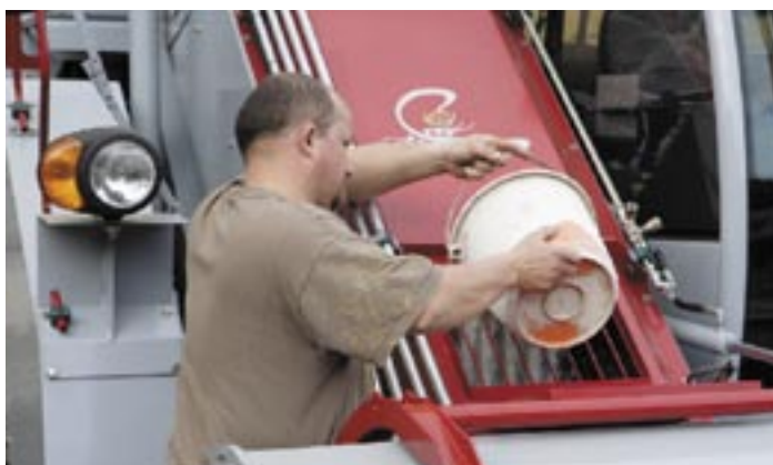
Am unteren Ende des Entnahmearms lassen sich durch eine Luke kleine Mengen von Futterkomponenten einfüllen. Dazu muss vorher mit einem Taster das Förderband aktiviert werden.
