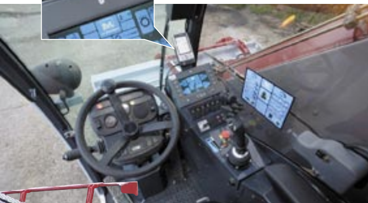
Die klimatisierte Kabine bietet mit der „One-Display“-Philosophie von BvL einen aufgeräumten Arbeitsplatz. Der Pocket-PC kann beispielsweise beim manuellen Einfüllen von Kleinstmengen entnommen werden.
